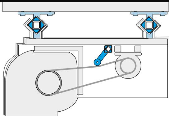
Ils peuvent être fixés en toutes positions, aussi bien au sol qu'au plafond ou sur une paroi verticale. Ces éléments, en outre, offrent une très grande sécurité. Les blocs de caoutchouc fermement coincés à l'intérieur du tube ne peuvent se dégager. Il n'y a pas de risque de décollement comme cela se produit avec des éléments vulcanisés.
