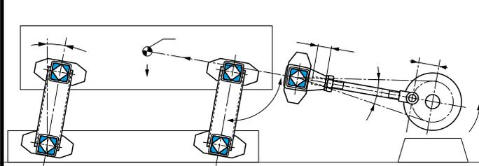
Ces bras sont conçus pour équiper des trieurs ou des cribles superposés qui oscillent en sens inverse ou pour des tables simples équilibrées par un contrepoids marchant en sens opposé, également pour des goulottes ou des transporteurs à secousses.
