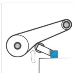
Tendeur élastique de courroie et de chaîne
