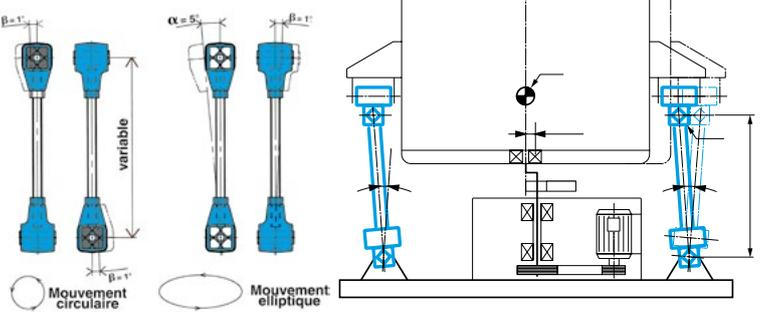
ceux des autres éléments Rosta, d'où un amortissement des oscillations et une atténuation de la transmission au plafond ou au toit, des vibrations de toutes sortes. La liaison avec la structure du plafond se fait au moyen d'une tige filetée, ou à extrémités filetées (voir cote N), sauf pour le type AV 50, pour lequel la liaison se fait par 2 x 4 vis M 12 x 25.
